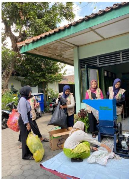
**Gambar 4.** Proses pemotongan sampah plastiik di kelurahan Notoprajan
